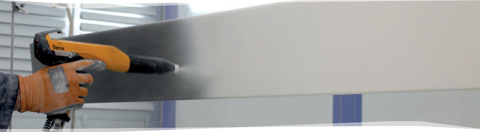
Siamo provvisti di impianti grandi fino a 15 metri per la verniciatura a polvere, un impianto automatico a cinque stadi con cabina e pistole Nordson in fase densa con cabina di fondo e forno IR.
