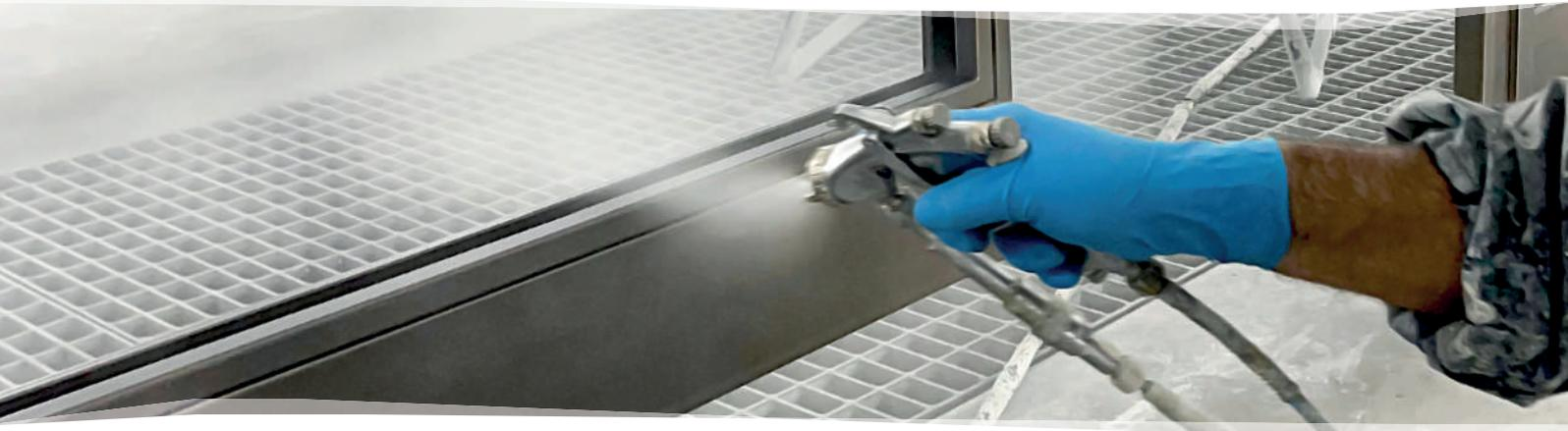
Disponendo di **pistole airless a pompa e pistone**, possiamo dare il giusto grado di finitura e con l'impiego di un **tintometro** possiamo formulare tutte le tonalità di colore utilizzando prodotti epossidici, poliuretanici, rapida essiccazione, acrilici, ferro micacei per finire alle vernici ignifughe REI 60, 90 e 120.
